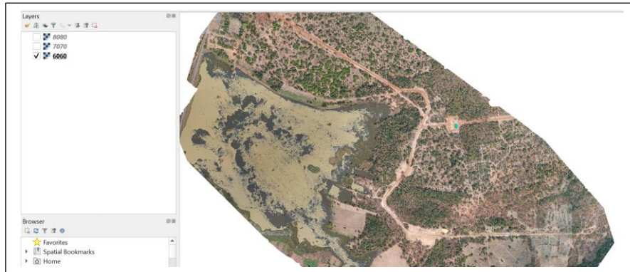
รูปที่ 6 แผนที่การบิน Overlap 60/60 ความสูง 300 เมตร ส่วน 1:10000
