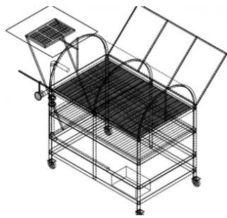
รูปที่ 3 อุปกรณ์อบลมร้อนแบบพาลาโบลาดมต้นแบบ
