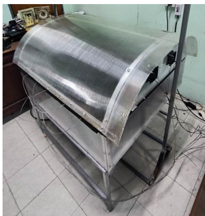
รูปที่ 1 ตู้อบแห้งพลังงานแสงอาทิตย์ชนิดหลังคาพาราโบลา ขนาด 1x1 m2
