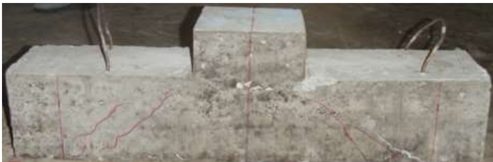
ภาพที่ 4 การวิบัติของคาน A ภายใต้แรงเฉือน
