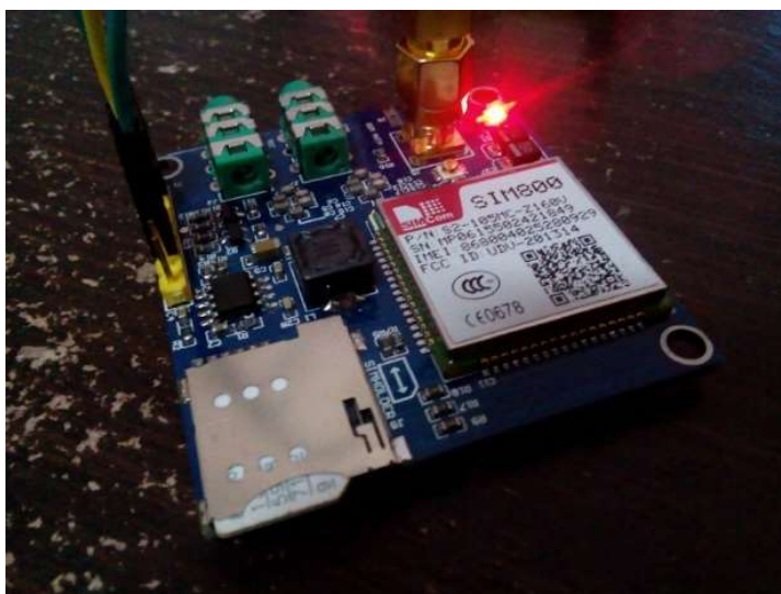
ภาพที่ 5 ขั้นตอนทดลองการทำงานแสดง SIM800 MODULE โดยใช้ MICRO SIM
