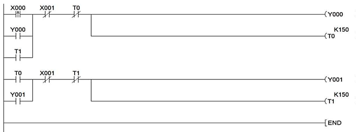
ภาพที่ 6 แบบวงจรแลตเตอร์ไดอะแกรมควบคุมมอเตอร์เหนี่ยวนำ 3 เฟส สลับการทำงานโดยอัตโนมัติ
