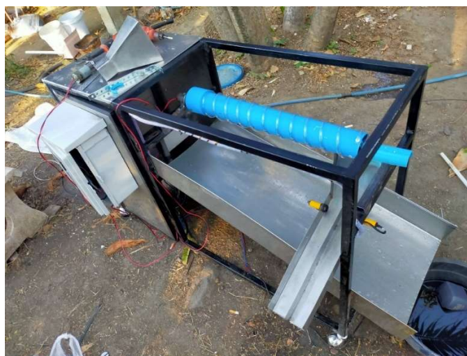
จ) ผลการออกแบบและสร้างเครื่องปอกเปลือกไข่ไก่กระเทียม
