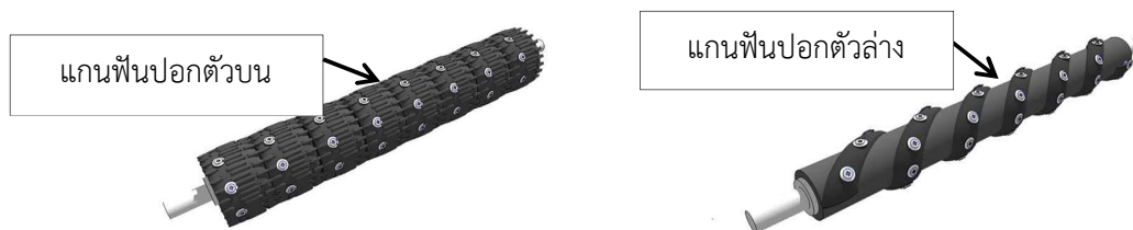
ภาพที่ 2 นวัตกรรมแกนพันปอกตัวบนและแกนพันปอกตัวล่างที่ออกแบบใหม่
