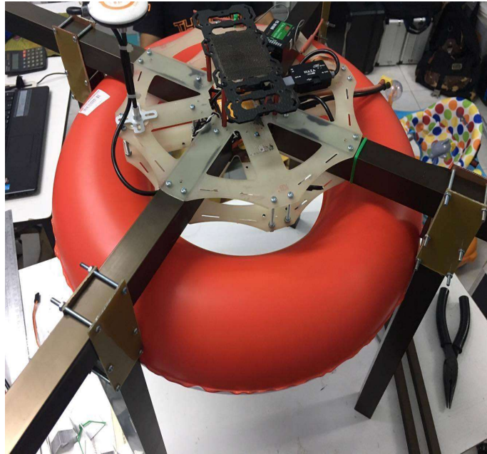
ภาพที่ 4 การติดตั้งเซอร์โวมอเตอร์และห่วงยาง
