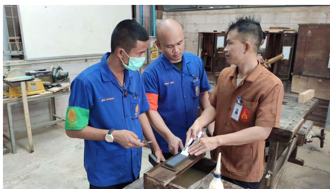
ภาพที่ 3 ผู้สอนสาธิตขั้นตอนการลับใบมีดของกบไสไม้
