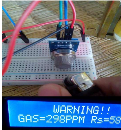
ภาพที่ 4 ขั้นตอนการทดลองทำงานการปล่อยแก๊สกับหัวเซนเซอร์ MQ-2
