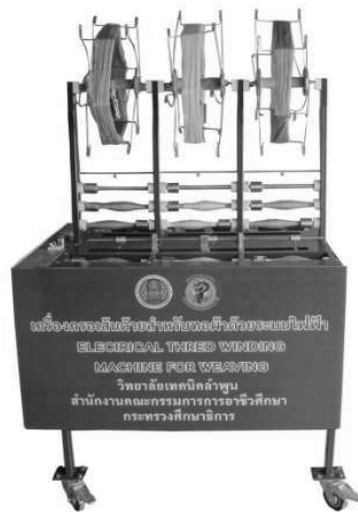
ภาพที่ 3 เครื่องกรอเส้นด้ายสำหรับทอผ้าด้วยระบบไฟฟ้า
