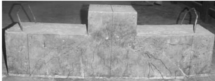
ภาพที่ 8 การวิบัติของคาน C ภายใต้แรงเฉือน
