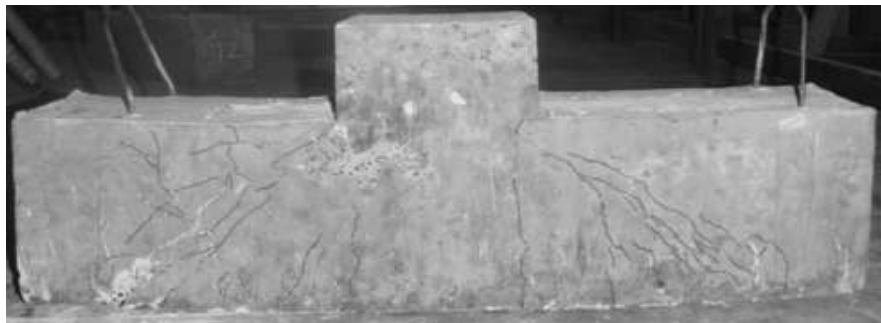
ภาพที่ 6 การวิกฤติของคาน B ภายใต้แรงเฉือน
