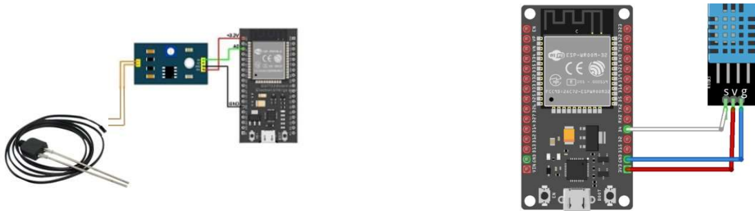
ก) การต่อใช้งานกับเซนเซอร์วัดความชื้นในดิน
