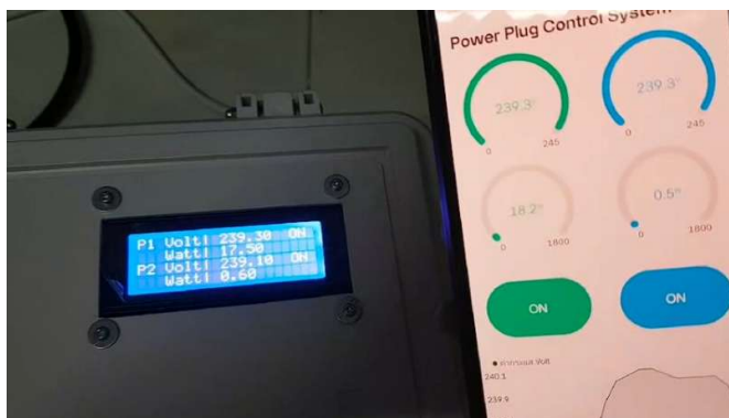
ภาพที่ 7 สามารถควบคุมการเปิด - ปิด ผ่านแอปพลิเคชันบนระบบปฏิบัติการแอนดรอยด์
