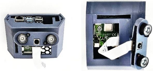
ภาพที่ 2 กล่องใส่อุปกรณ์ประกอบด้วย Raspberry PI 4 และกล้อง
