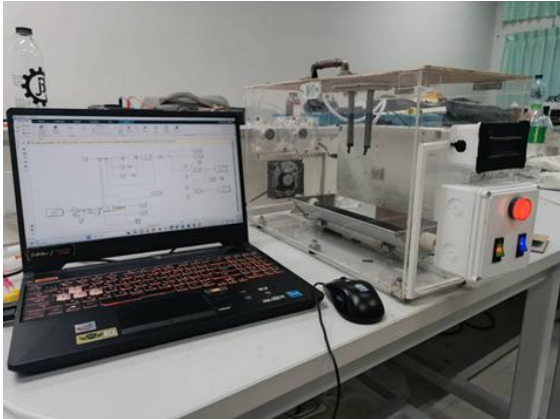
ภาพที่ 1 ชุดทดลองกระบวนการควบคุมอุณหภูมิ
